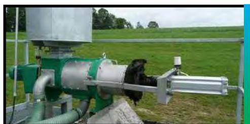
Ainsi, on retrouve une phase liquide diminuée en volume, et une phase solide à 25 % MS (suivant réglages). La phase solide s'accumule en tas sur une plateforme, alors que la phase liquide s'écoule dans la seconde fosse de stockage.
